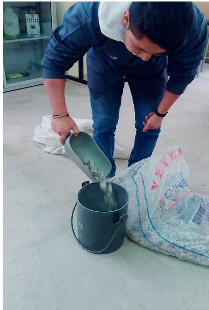
Figura 4: Selección y medición del agregado grueso para utilizar en la mezcla de hormigón
