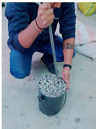
Figura 3: Separación de la masa unitaria compacta
