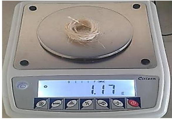
Figura 7: Ensayo de Densidad Lineal del monofilamento de coco.
