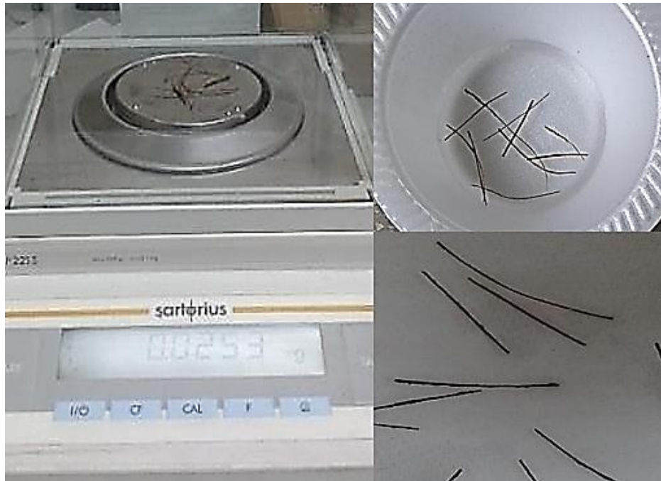
Figura 9: Ensayo de Absorción de las Fibras de coco-Peso SSS
