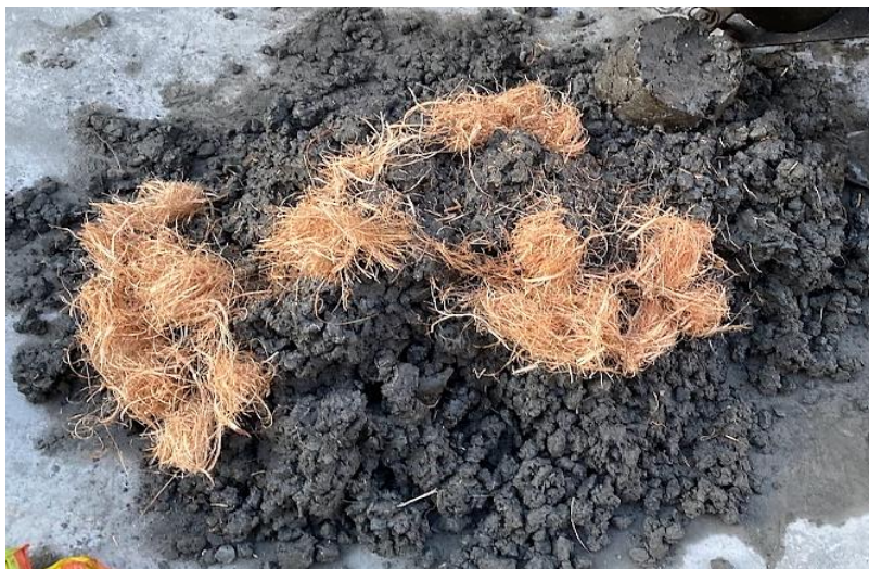
Figura 15: Representación gráfica de la inclusión de fibras de coco a la mezcla de hormigón f_c 240
