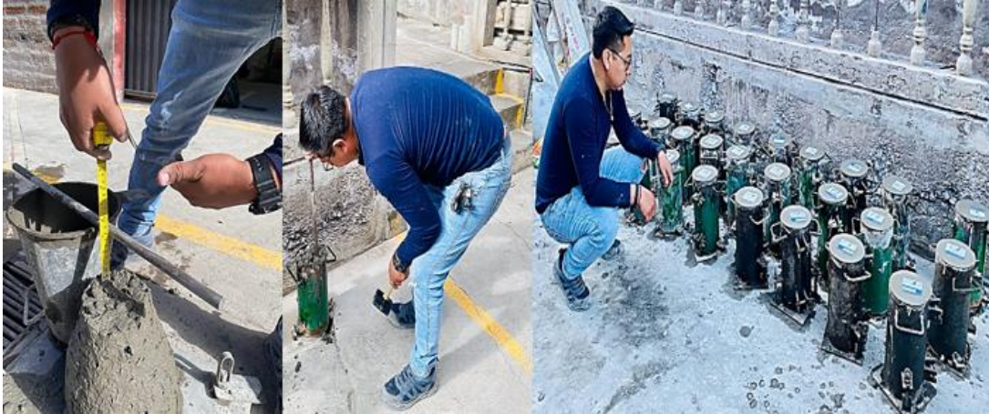
Figura 14: Ensayo de asentamiento y elaboración de cilindros de hormigón f_c 240 \text{kg}/\text{cm}^2
