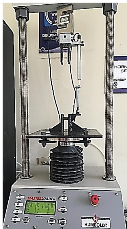
Figura 11: Máquina para ensayo a tracción del monofilamento de coco
