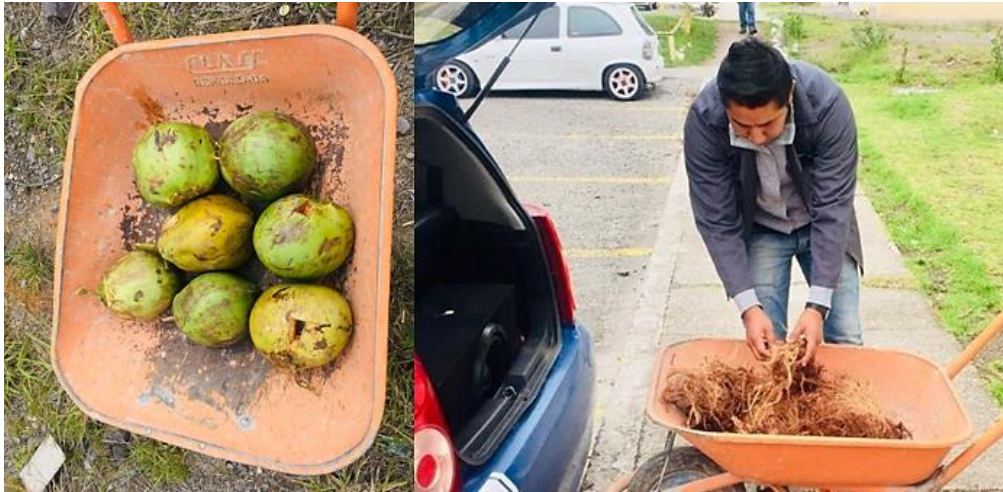
Figura 5: Monofilamentos de coco para utilizar en el hormigón a diseñar.
