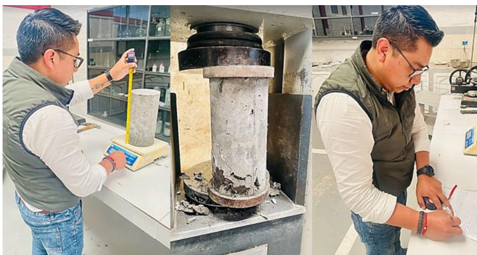
Figura 16: Toma de datos del ensayo a compresión del cilindro de Hormigón de f'c 240 \text{kg/cm}^2
