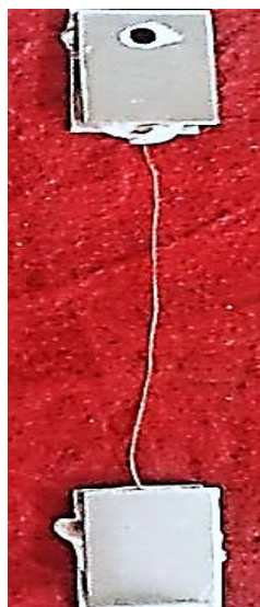
Figura 10: Ensayo de Tracción de las Fibras de coco
