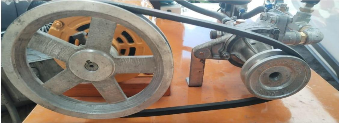
*Nota:* En la figura se aprecia el motor eléctrico conectada promedio de una banda para trasmitir el torque a la bomba de agua
