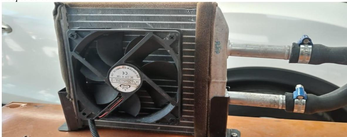
*Nota:* El radiador, para funcionar de manera óptima, debe recibir un flujo de aire por tal razón se instaló en la parte posterior del mismo un electro ventilador para permitir una correcta Refrigeración.
