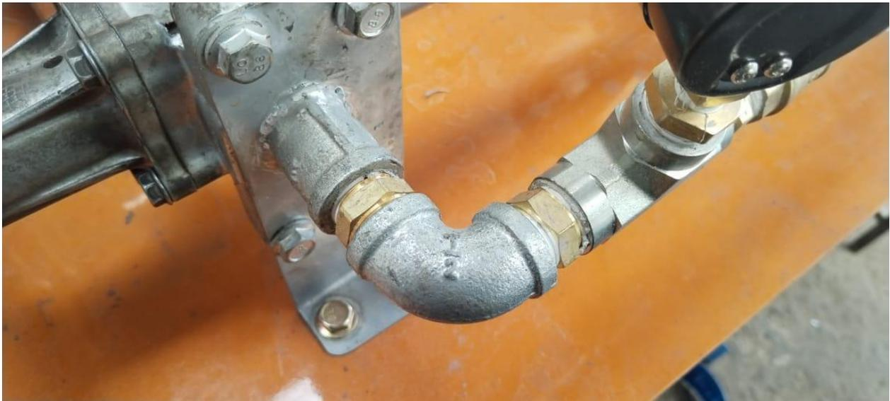
**4. Instalación de un manómetro de presión y llave de paso**
