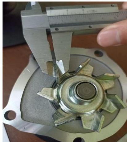
**Nota:** En la imagen el impulsor este sobrepuesto en la bomba de agua para facilitar la toma de datos
