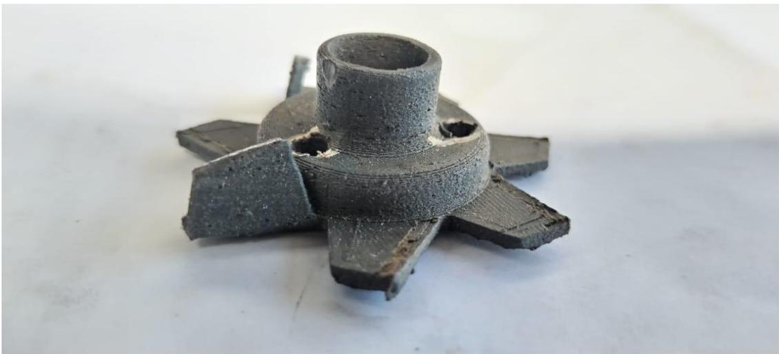
Deformación y rotura total de las aspas y de todo el impulsor a 80°C
