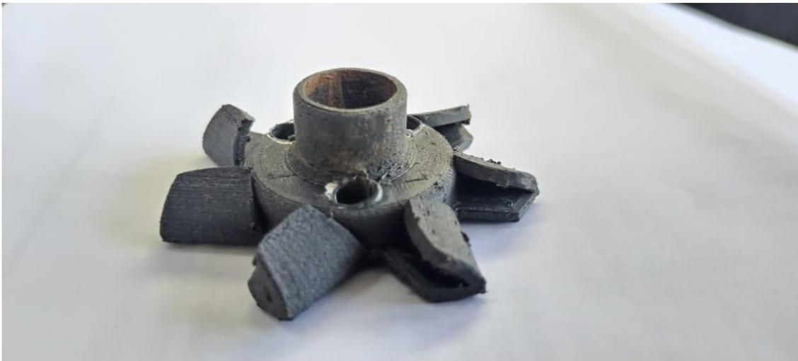
Deformación de aspas, rotura de las aspas, deformación total a 75°C, pérdida de presión
