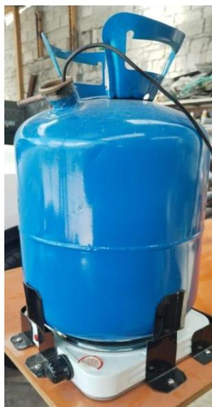
**Nota:** Para poder subir la temperatura del sistema el tanque metálico debe estar en contacto directo con la cocineta y para evitar cualquier movimiento inesperado este es ajustado en conjunto con la cocineta a la mesa metálica del banco de pruebas.
