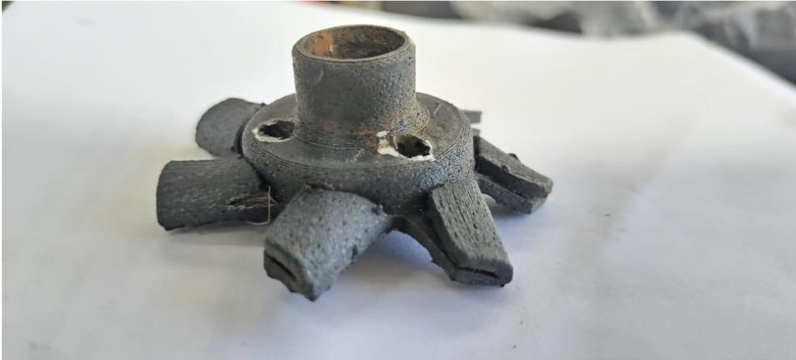
Deformación total de las aspas y de todo el impulsor (pandea), temperatura máxima 70°C
