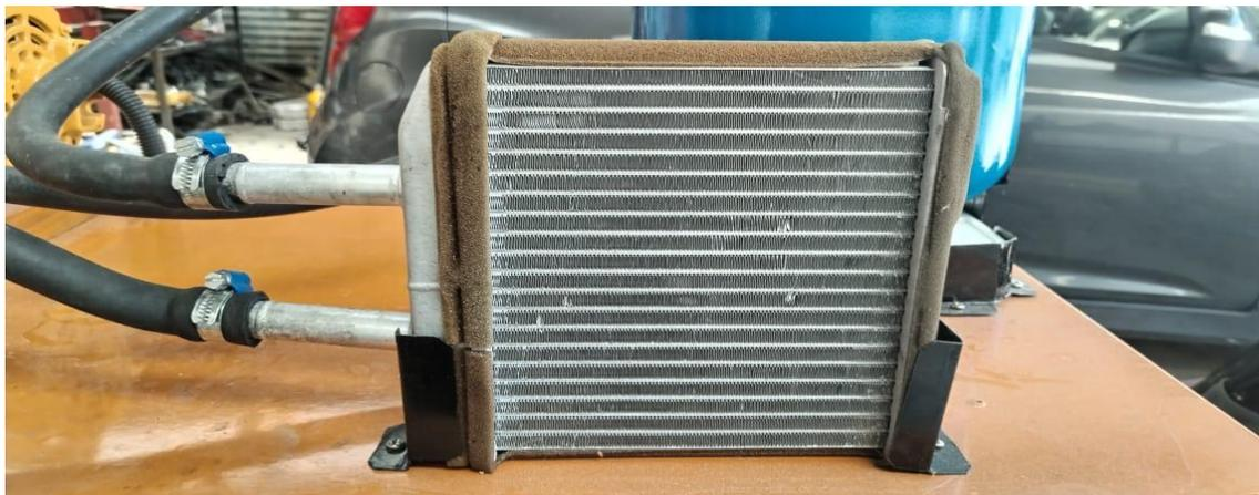
*Nota:* Para poder controlar la temperatura del líquido que circula en la que el banco de pruebas, la implementación de un radiador permite bajar la temperatura del líquido que sale de la bomba de agua.
