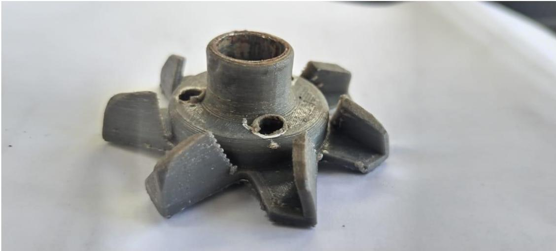
Deformación parcial de las aspas a 75°C, material se expande y se pandea hacia el interior
