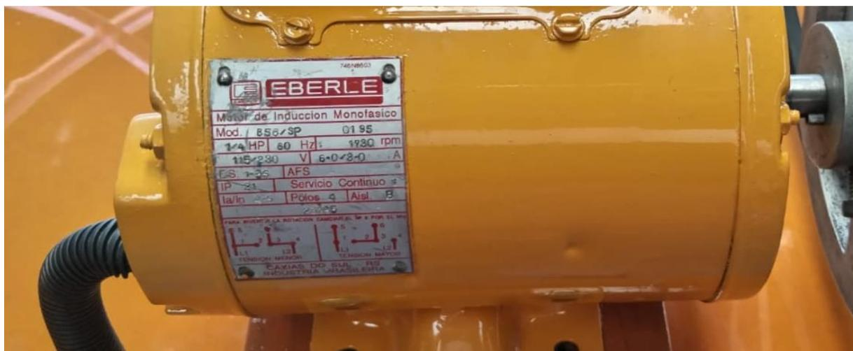
**Nota:** En la imagen se evidencian las especificaciones técnicas del propio fabricante del motor eléctrico, extraído de (Navarrete, 2022)
