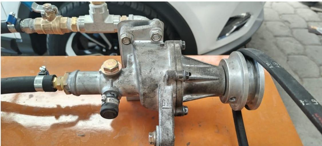
**Nota:** El tanque de agua tiene una salida directa a la bomba de agua la cual recibe este líquido y lo vuelve a impulsar al sistema repitiendo el ciclo de manera continua.
