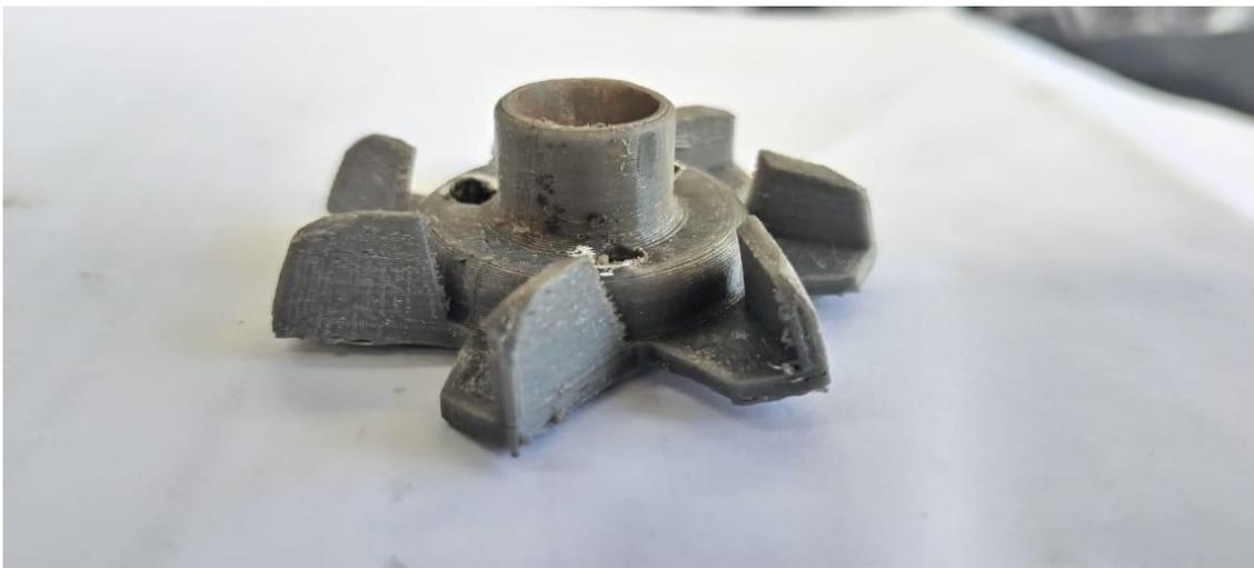
Rotura, deformación parcial del impulsor y se pandea.
