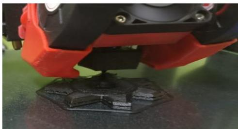
**Nota:** En la figura se presenta la placa de la impresora y la base del impulsor impreso.
