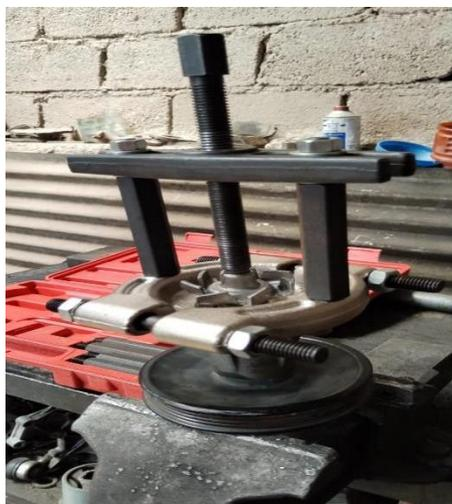
**Nota:** En la imagen se evidencia el uso del extractor de rodamientos para la extracción del impulsor de bomba de agua
