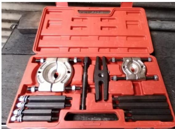
**Nota:** En la figura se evidencia el set de piezas que conforman al extractor de rodamientos,
