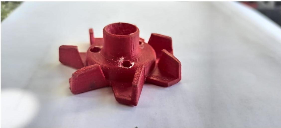
No existe deformación, no hay pérdida de presión y soporta la temperatura hasta los 80°C
