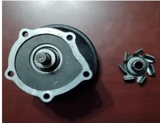
**Nota:** En la figura se muestra el cuerpo de la bomba de agua y el impulsor seccionado
