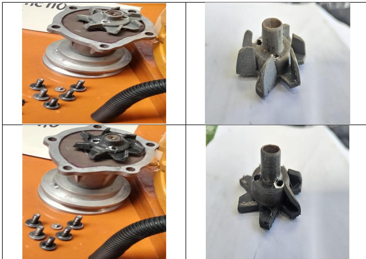
La presente validación de los diferentes tipos de impulsores tiene como principal motivo analizar su comportamiento de funcionamiento en una bomba de agua real, aplicando los diferentes tipos de materiales en deposición fundida, se realiza un banco de pruebas que se somete a temperatura ambiente y temperatura real de funcionamiento normal de motor, en la cual se obtiene los distintos resultados que se muestran en la tabla 23.
