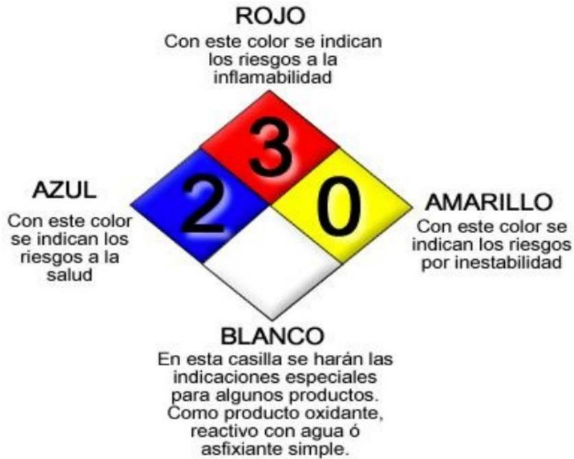
Figura 1. Diamante de seguridad NFPA 704
