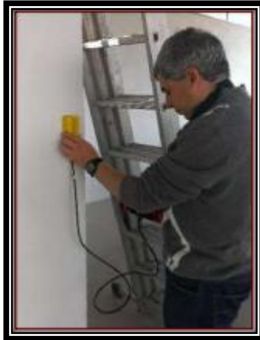
Figura 22. Escaneo con el Pachómetro
