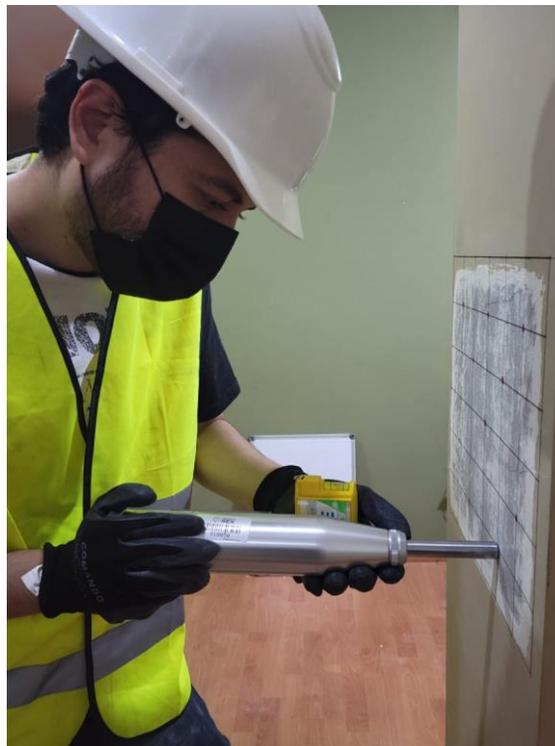
Figura 113. Nivelación del esclerómetro.
