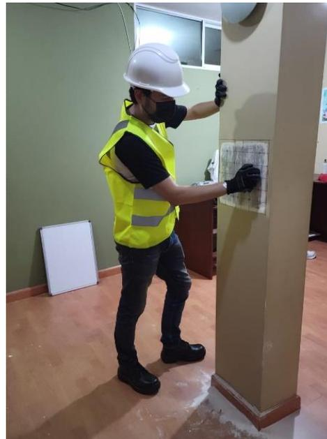
Figura 59. limpieza de superficie de ensayo.
