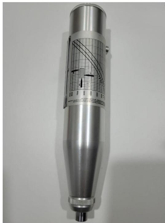
Figura 111. Esclerómetro.
