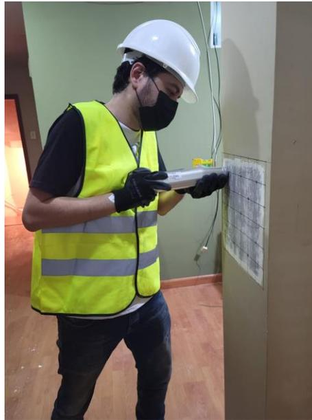
Figura 60. Ensayo de Esclerometría.
