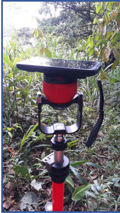
Descripción: Obtención de datos con el GPS para determinar la ruta del trazado de la vía.
