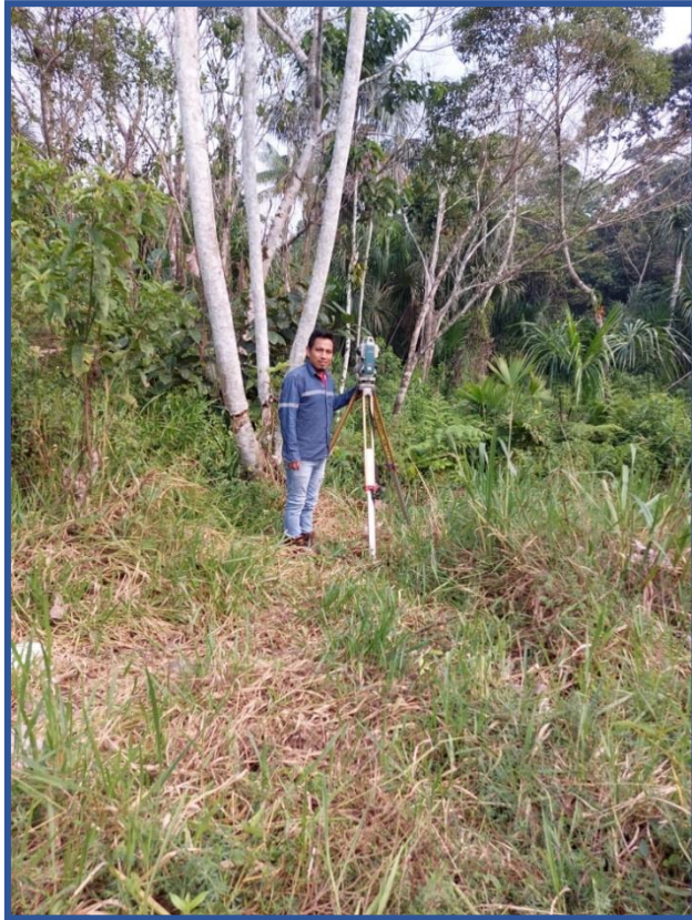
Descripción: Implantación de la estación total en campo.
