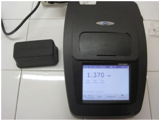
Foto 9: Espectrofotómetro UV- visible HACH DR 2800 (Clorofila a y Fósforo Total)
