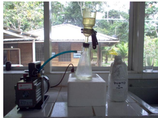
Foto 8: Bomba de vacío para filtración De muestras de agua. (Peñaherrera, 2010)
