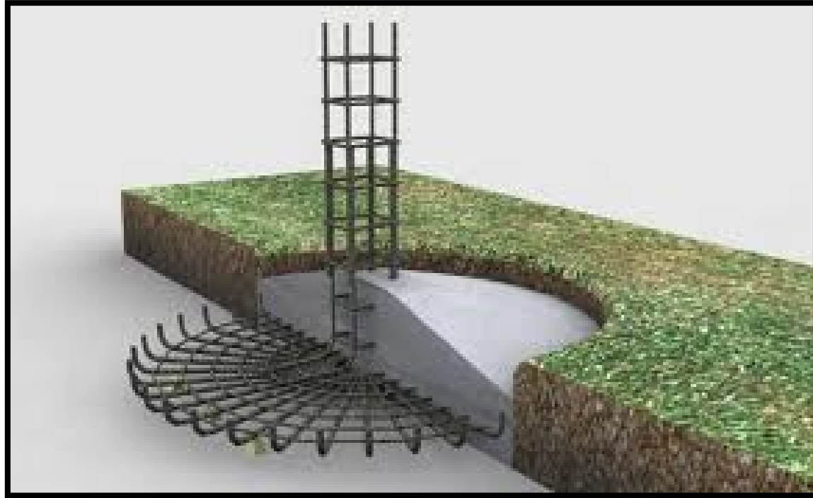
Ilustración 7. Cimentación de una edificación
