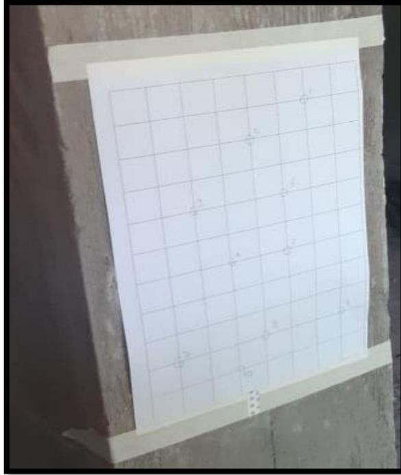
Figura 3.2. Ensayo esclerómetro (cuadrícula).
