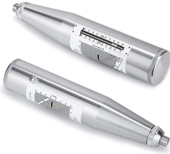
Ilustración 21 Fotografía del equipo utilizado (esclerómetro).
