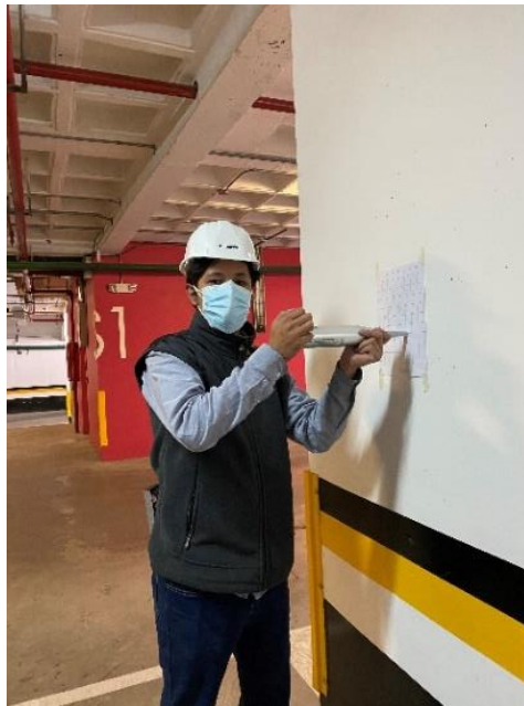
Figura 39: Prueba esclerómetro in situ.
