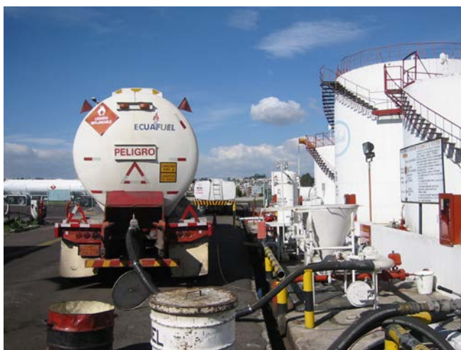
Imagen 10-31-4. Auto tanque despachando JET A1. A su derecha se ve el conjunto de filtros. Ecuafuel
