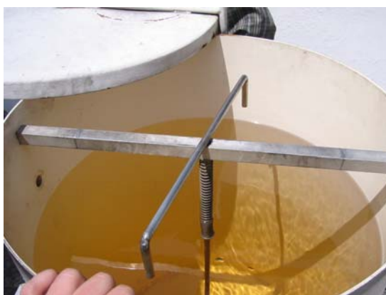
Imagen 7-6 Sistema de recepción de JET A-1 para pruebas cortas y proceso de filtrado. Ecuafuel (Aeropuerto Mariscal Sucre)
