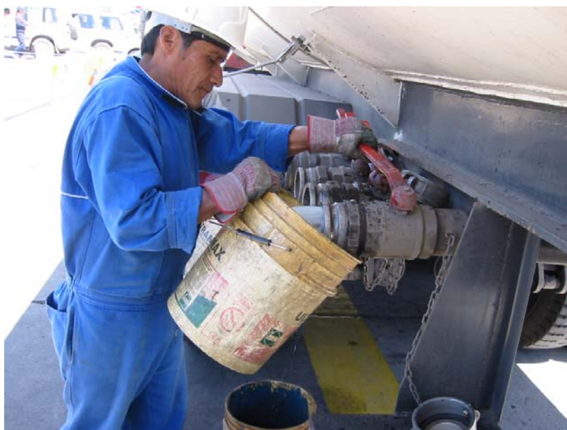
Imagen 1-25. Toma de muestra de combustible. Petrocomercial ES
