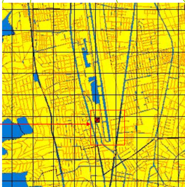
Imagen 8-2. 8-3 Grilla de cálculo sobre el DMQ. Acercamiento sobre una fuente estacionaria puntual de emisión
