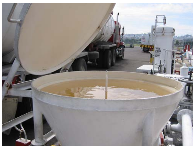
Imagen 10-21-3. Inspección visual y revisión de densidad, primera fase de pruebas abreviadas. Ecuafuel.
