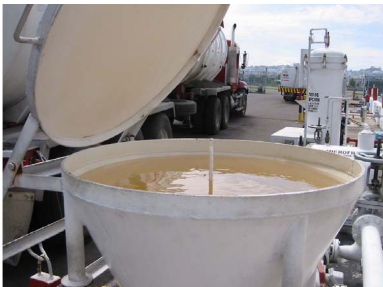
Imagen 1-1. Inspección visual y revisión de densidad, primera fase de pruebas abreviadas. Ecuafuel.
