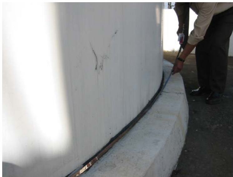
Imagen 11-7. Medición manual de circunferencias de tanques de almacenamiento. Ecuafuel.
