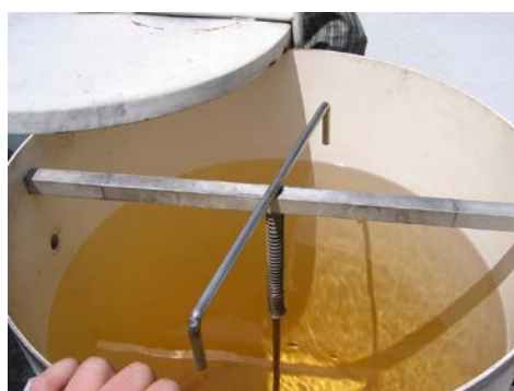
Imagen 7-37-4 Sistema de recepción de JET A-1 para pruebas cortas y proceso de filtrado. Ecuafuel (Aeropuerto Mariscal Sucre)
