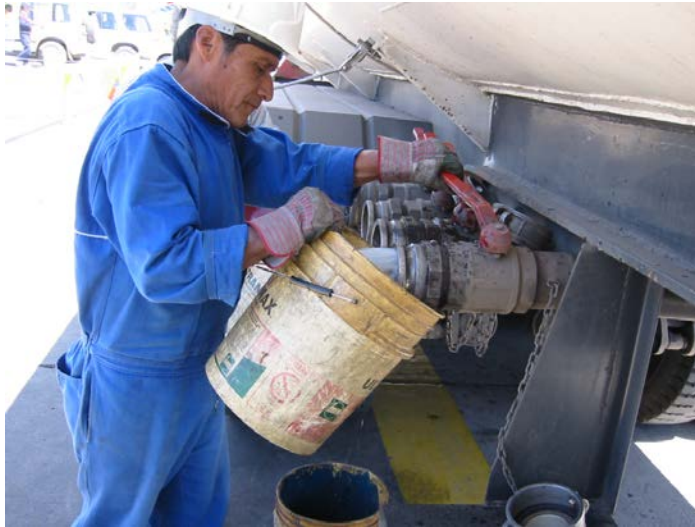
Imagen 10-16 11-17 . Toma de muestra de combustible. Petrocomercial ES
