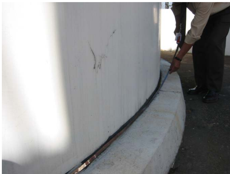
Imagen 11-7. Medición manual de circunferencias de tanques de almacenamiento. Ecuafuel.
