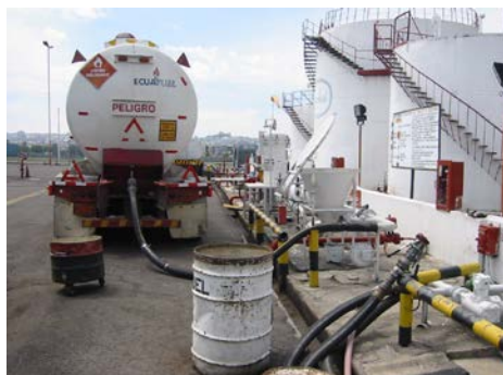
Imagen 7-4 Sistema de filtrado y pruebas cortas previo a ingreso a tanques
