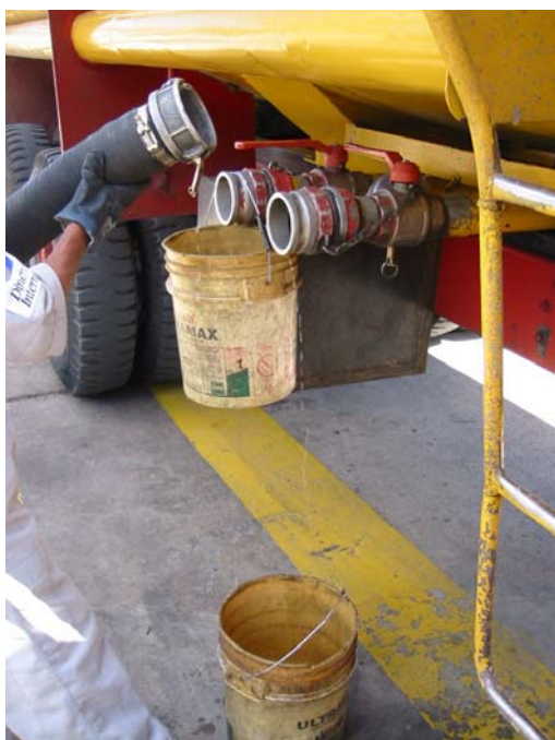
Imagen 1-28. Acople de manguera de válvula de salida de auto tanque. Petrocomercial ES (derecha)
