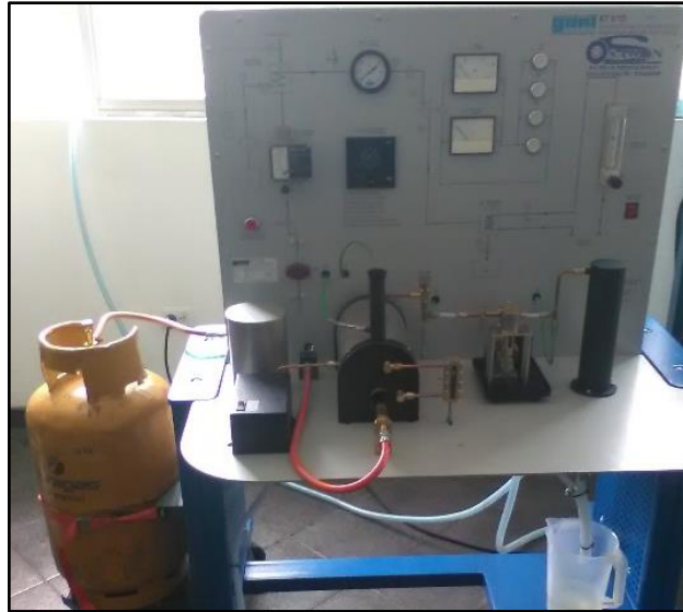
Figura 2. Central térmica de vapor con máquina de vapor
