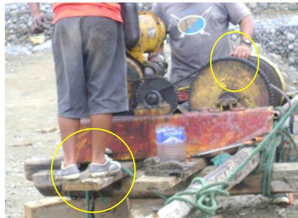
El personal no utiliza ni la vestimenta apropiada ni el Equipo de Protección Personal necesario (zapatos, guantes)
