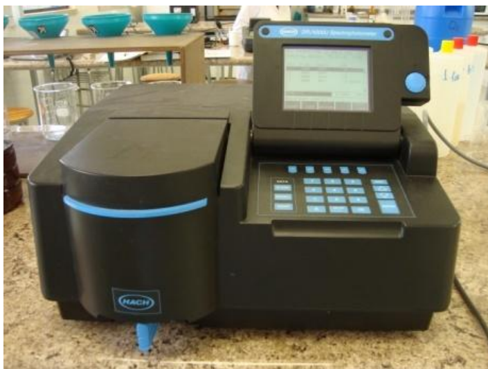
Fotografía 3.25: HACH DR/4000 U Spectrophotometer
