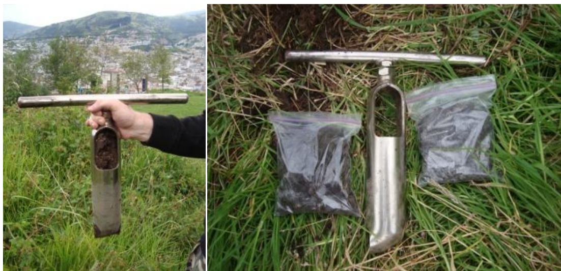
Fotografías 3.6 y 3.7: Toma de muestras de suelo
