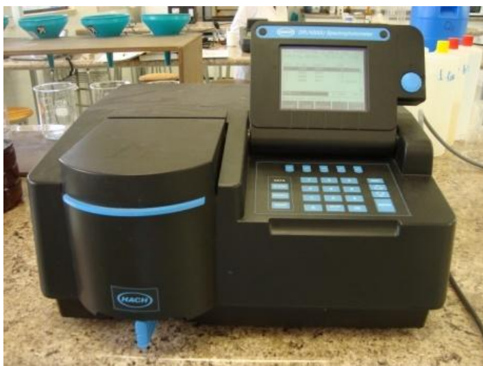
Fotografía 3.23: HACH DR/4000 U Spectrophotometer
