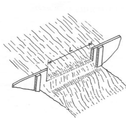
Gráfico 2.9: Vertedero de pared delgada con una contracción
