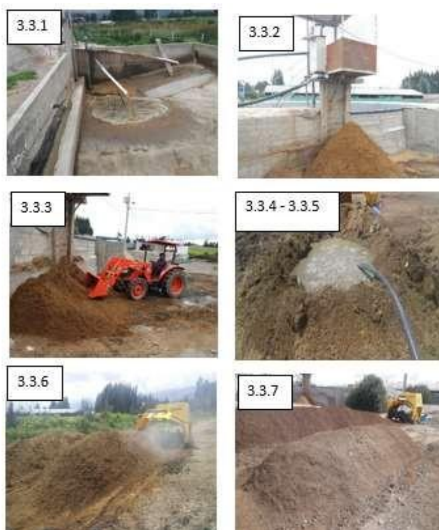
Figura 3. Fases del compostaje en el Cantón Latacunga de la provincia de Cotopaxi, Ecuador. 3.3.1. Tanque de recepción de aguas residuales. 3.3.2. Separador de sólidos de tornillo. 3.3.3. Tractor con pala frontal utilizado para transportar material separado y armar pilas. 3.3.4- 3.3.5. Inyección de concentrado de estiércol y dosificación de inoculante microbiano. 3.3.6. Volteo. 3.3.7. Toma de parámetros de control.
