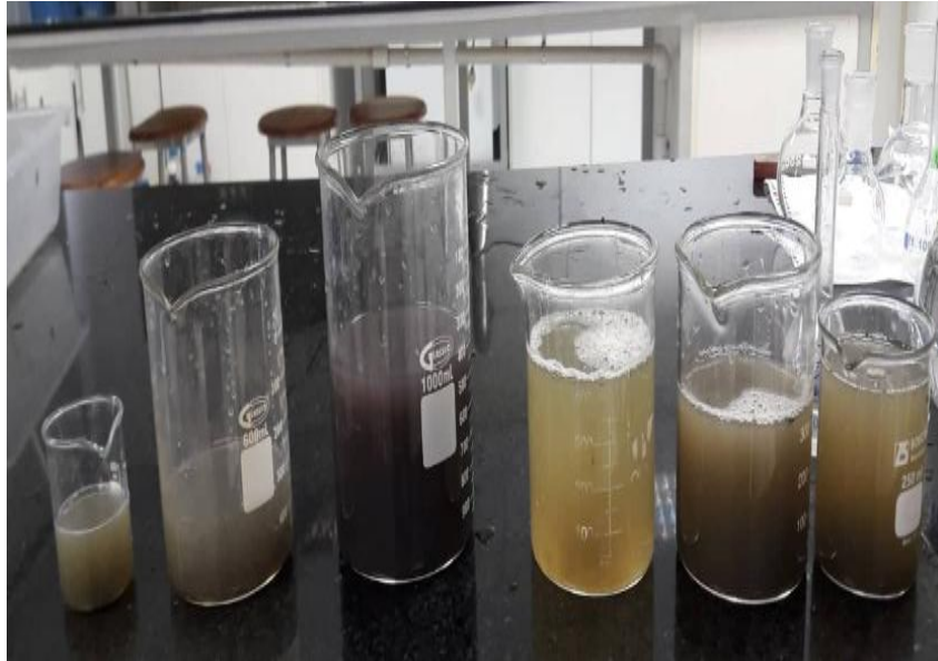
Imagen: Purificación del alginato mediante los métodos del alginato de calcio y el ácido algínico respectivamente
