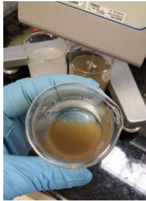
Imagen: Medición de la viscosidad de la solución de alginato de sodio comercial y obtenido al 1 % m/m
