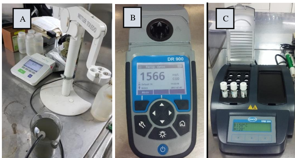
Figura 14. A) pH metro. B) Espectrofotómetro portátil DR-900 HACH. C) reactor DRB-200
