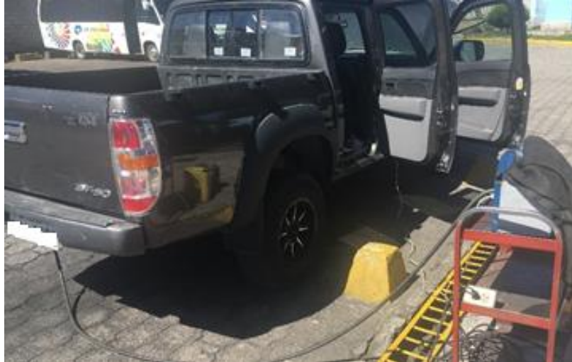
Figura 21. Vehículo en pruebas de opacidad.
