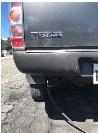
Figura 20. Sonda lambda conectada al tubo de escape.
