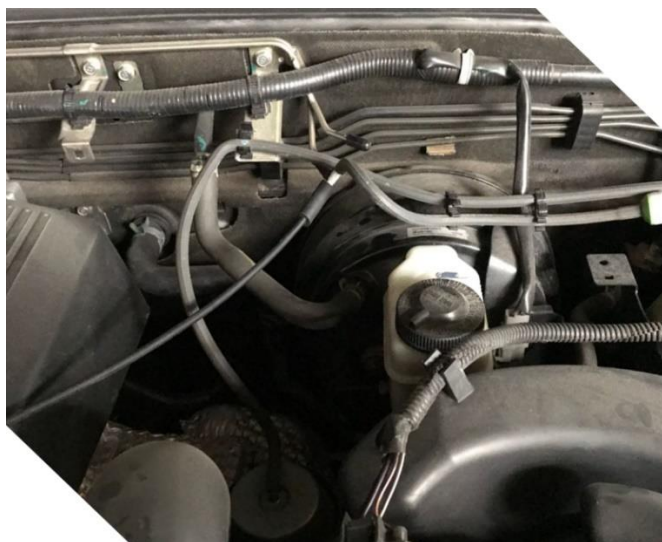
Figura 14. Acople de presión asociado al turbo del vehículo.
