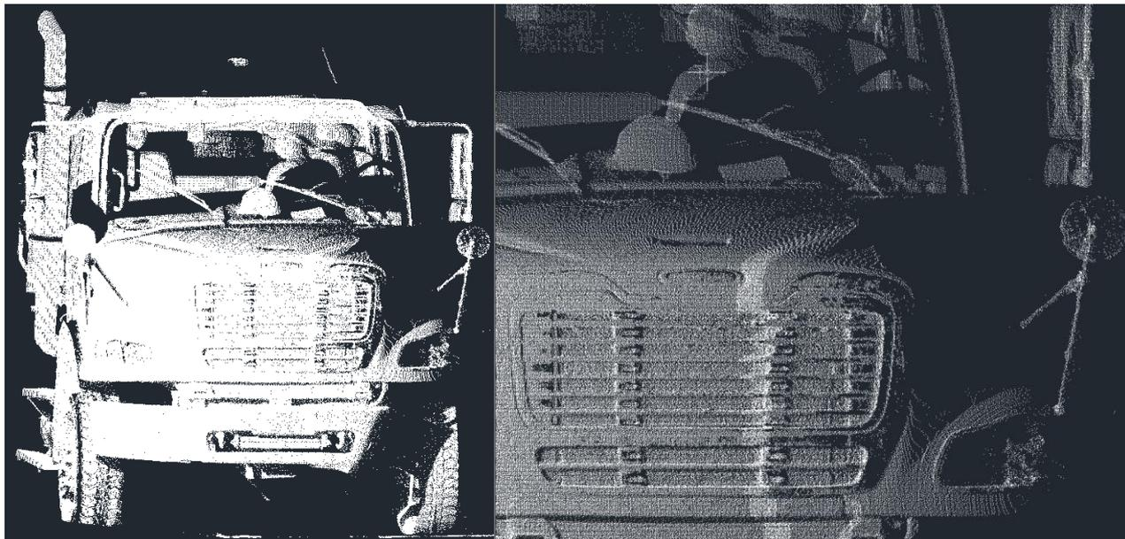
**Ilustración 4** Nube de Puntos del Camión
