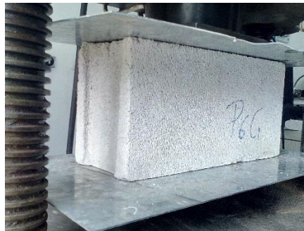
Figura 9. Compresión del bloque de concreto.
