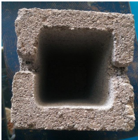
Figura 10. Probeta seca de hormigón
