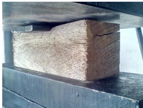
Figura 14. Compresión perpendicular a la fibra de la madera
