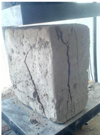
Figura 4. Compresión del adobe hasta la falla.
