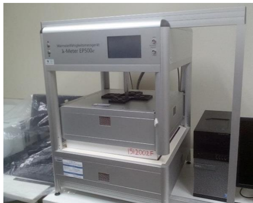
Figura 20. Máquina de ensayos térmicos de la ESPOL.
