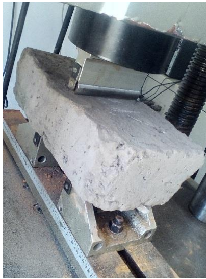
Figura 5. Flexión para ladrillo de adobe.
