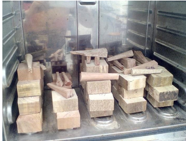
Figura 19. Especímenes preparados de los ensayos de madera.
