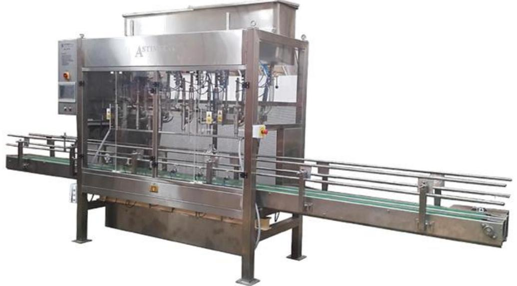
**APLICACIÓN:** Envasadora lineal automática con 6 estaciones de pesaje, especialmente diseñada para llenado rápido y con alta precisión de productos líquidos de baja y mediana viscosidad como aceite comestible, productos químicos de limpieza, agroquímicos, lubricantes, aditivos, etc., en envases plásticos de 5, 10, 15 y 20 litros.
