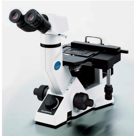
Figura 9. Microscopio metalográfico invertido marca Buehler 50x – 500x.
