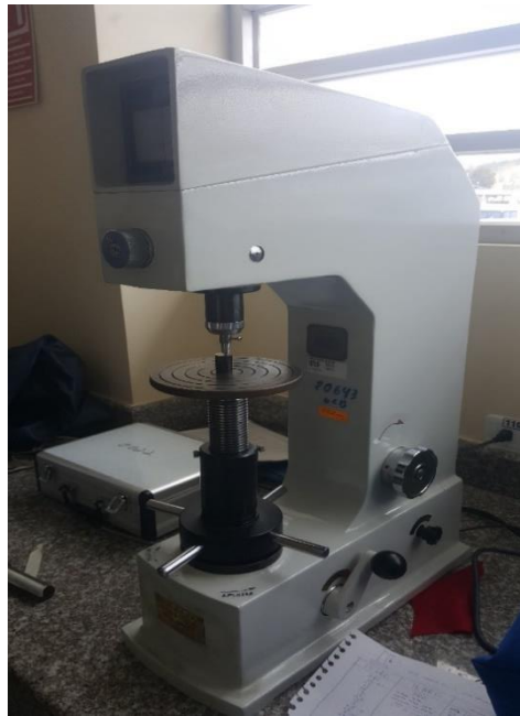
Figura 8. Durómetro Universal Huagin Modelo HBRV – 187,5 Kgf.
