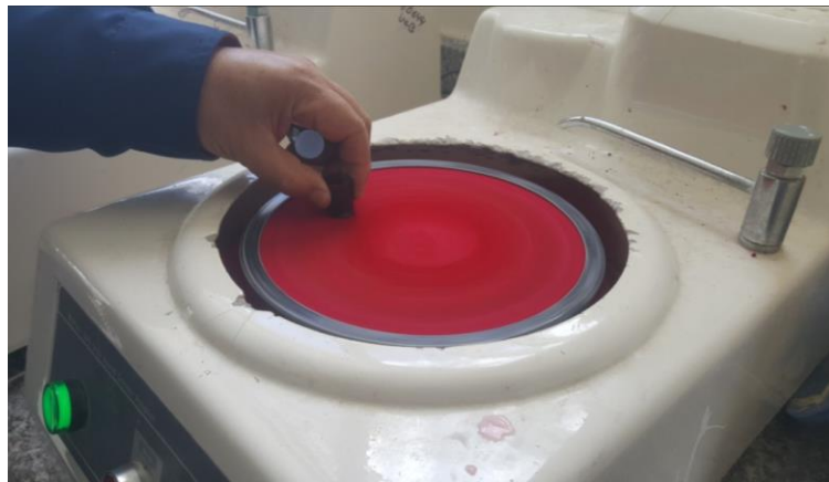
Figura 17. Pulido de la probeta.
