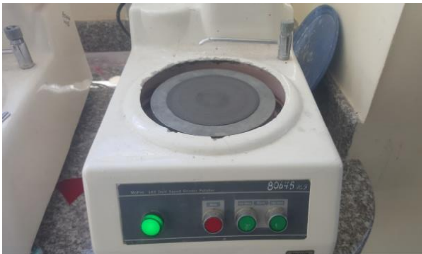
Figura 21. Pulidora con lija de circonio.
