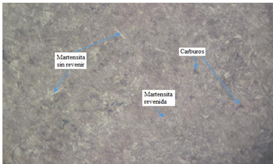
Figura 30. Microestructura de la barra estabilizadora parte recta a 500x atacada con nital 2.
