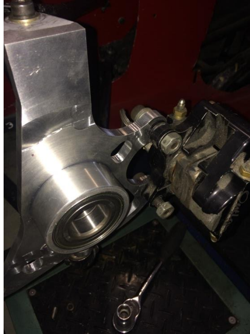
Figura 60. Verificación del anclaje de las mordazas de freno.
