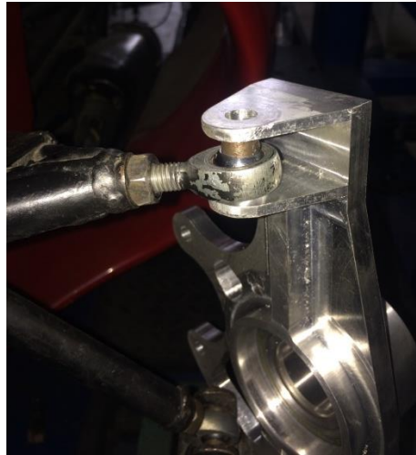
Figura 58. Verificación del anclaje superior de la suspensión.
