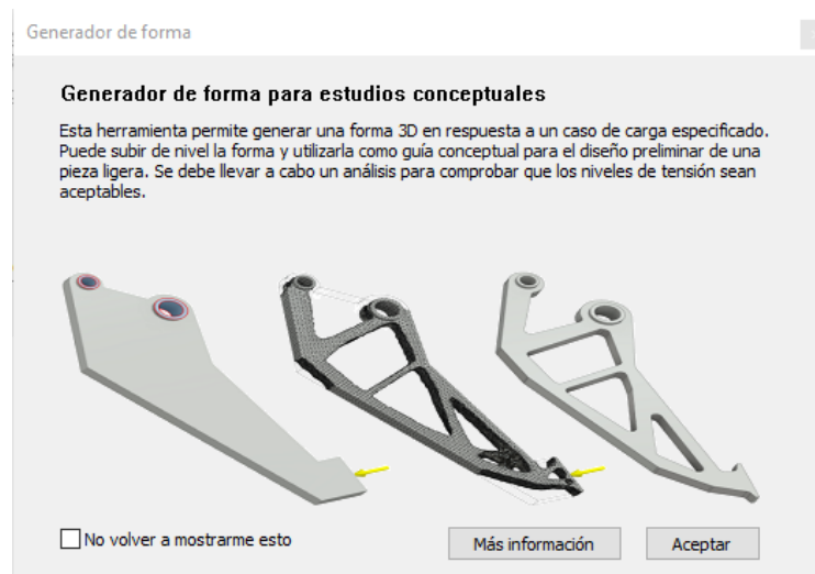
Figura 9. Activación del generador de forma en Inventor.
