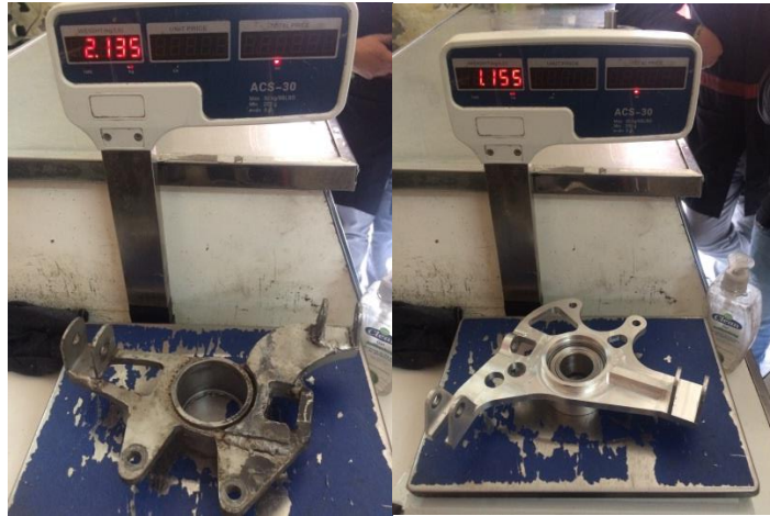
Figura 71. Pesaje de la mangueta de acero.
