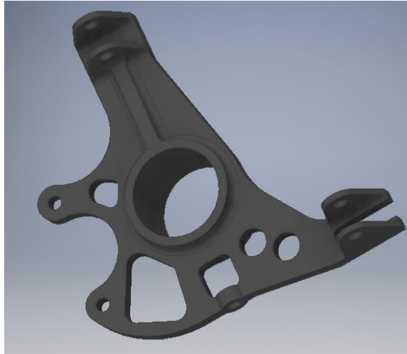
Figura 40. Incorporación del nervio al CAD en la zona afectada.
