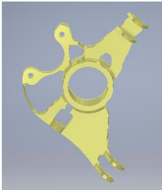
Figura 29. Mangueta optimizada por el software
