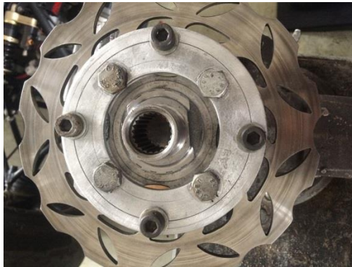
Figura 62. Instalación del disco de freno al adaptador.
