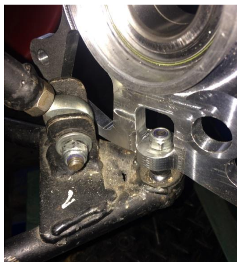
Figura 59. Verificación del anclaje inferior de la suspensión.
