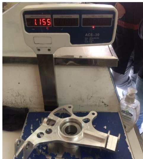
Figura 57. Pesaje de la mangueta con rodamiento.
