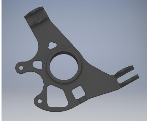
Figura 30. Mangueta optimizada con ayuda del software.
