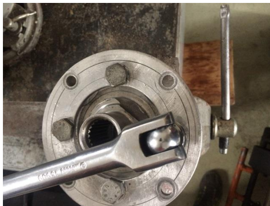
Figura 61. Instalación de la manzana y adaptador.
