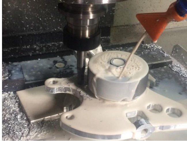
Figura 56. Proceso de alivianado de la mangueta.
