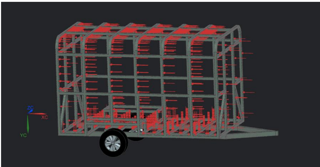
Figura 57. Visualización de la aplicación de la carga para el caso 6 del método LRFD NTE INEN 1323:2009
