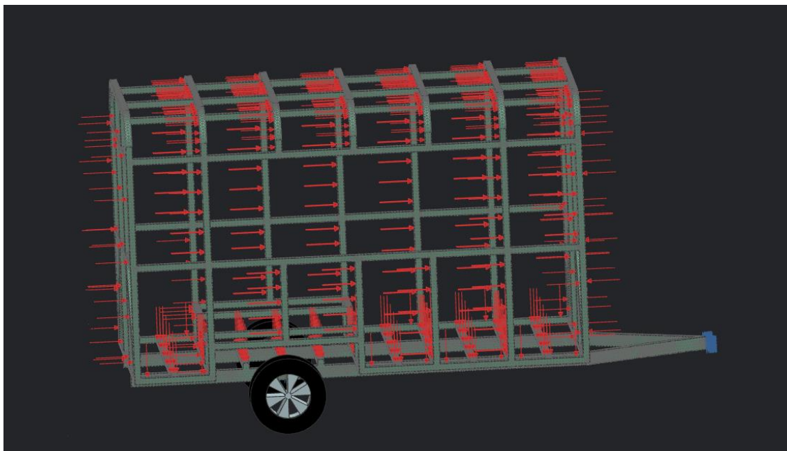
Figura 49. Visualización de la aplicación de la carga para el caso 4 del método LRFD NTE INEN 1323:2009
