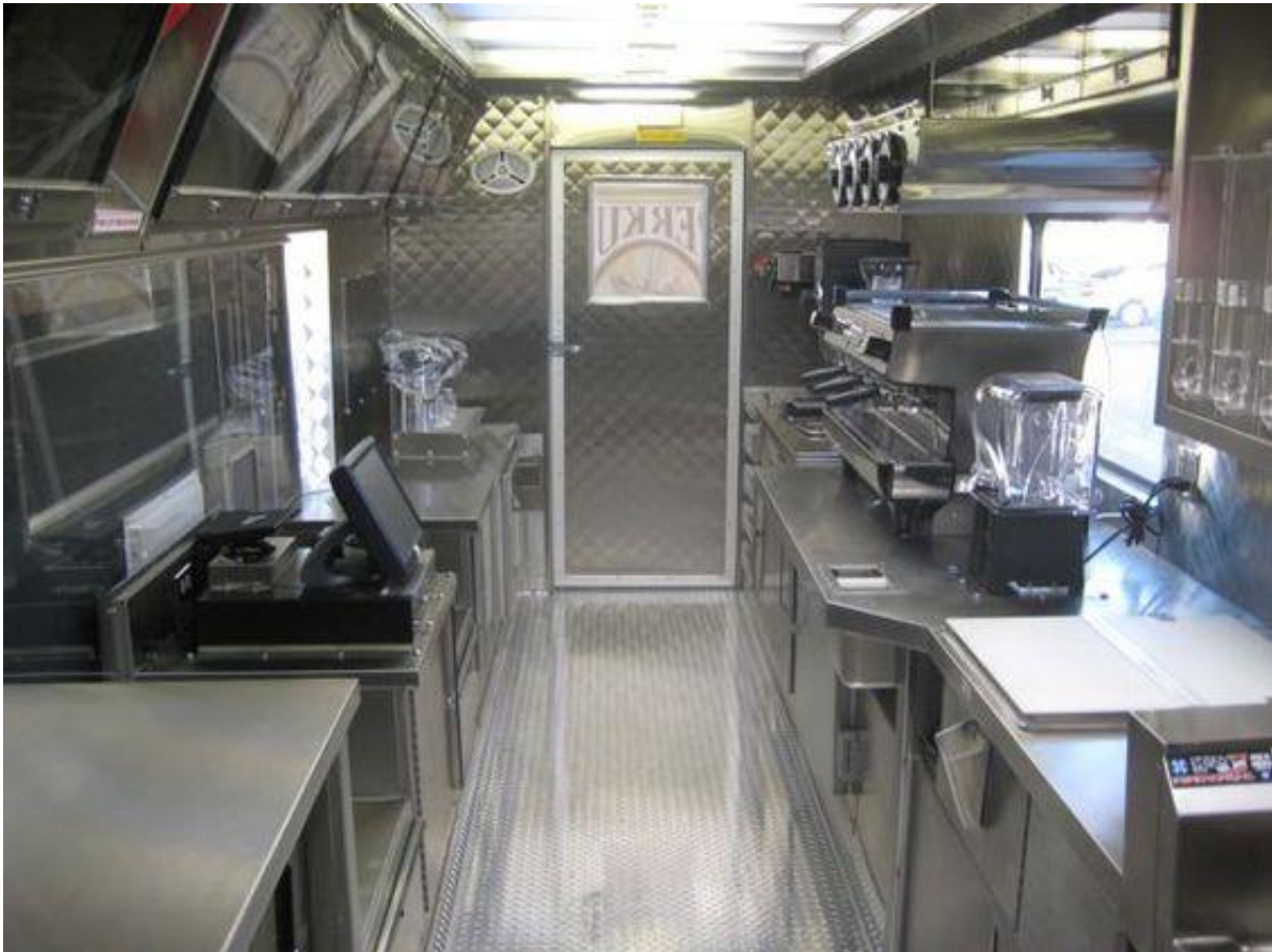
Figura 22. La carga muerta se conforma con todos los accesorios del establecimiento móvil
