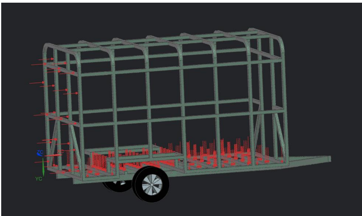
Figura 61. Visualización de la aplicación de la carga para el caso 7 del método LRFD NTE INEN 1323:2009
