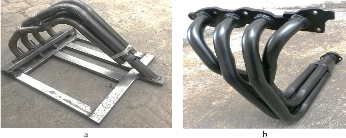
Figura 50. Múltiple de escape 4-1, tipo A: (a) proceso de construcción, (b) resultado final.
