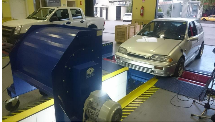
Figura 26. Vehículo de pruebas en dinamómetro de chasis LPS 3000
