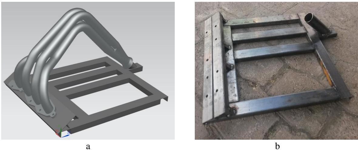
Figura 49. Base para soldadura de múltiples de escape conforme al diseño: (a) modelo CAD, (b) construcción.
