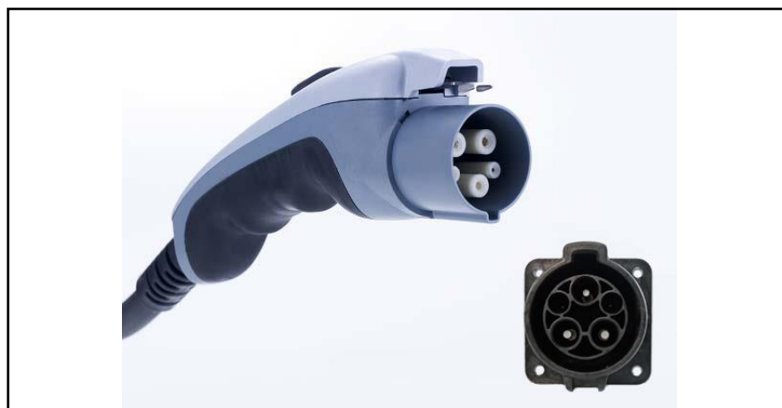
Figura 7. Conector Yazaki, conocido como conector tipo 1. Fuente: (Iriarte, 2012)
