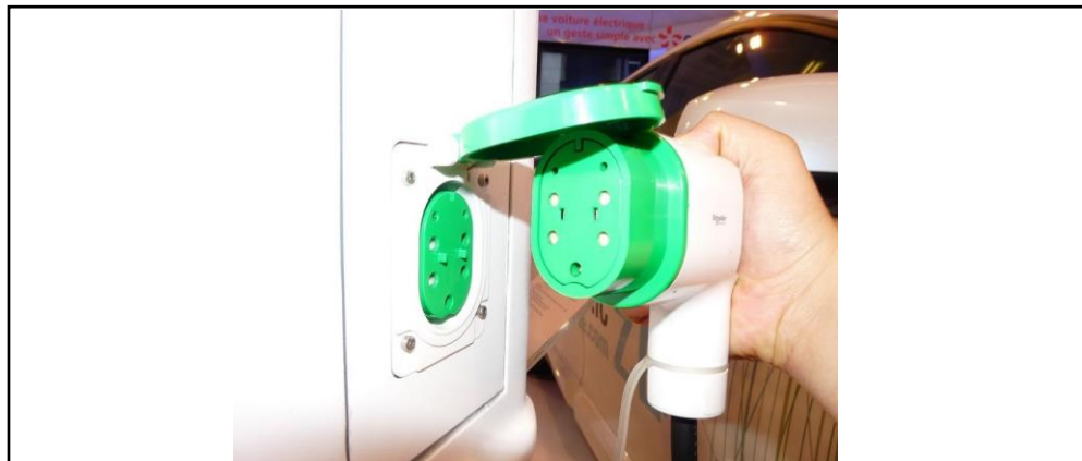
Figura 9. Conector Scame, conocido también como conector tipo 3. Fuente: (Iriarte, 2012)
