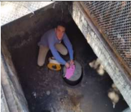
Fotografía 3: Toma de nivel piezométrico
