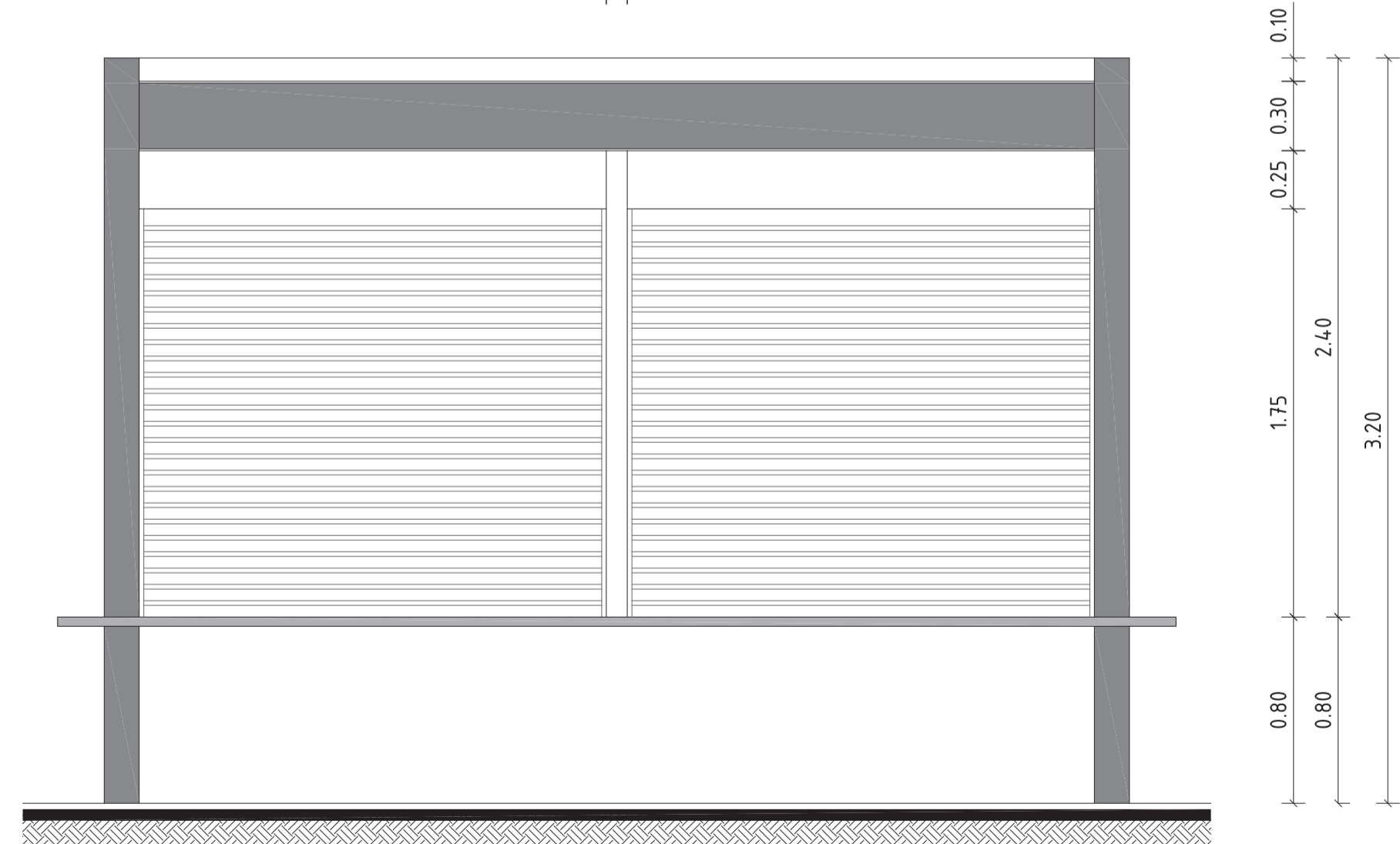
FACHADA LATERAL MODULO TIPO
