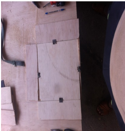
Elaboración de molde 30 x 30 cm, espesor 8cm.
