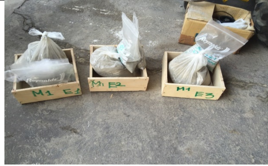
Dosificación de materias primas para cada ensayo testigo
