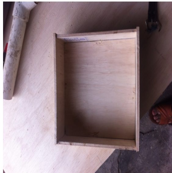
Molde Terminado Dimensiones: 30 x 30 cm Espesor: 8cm
