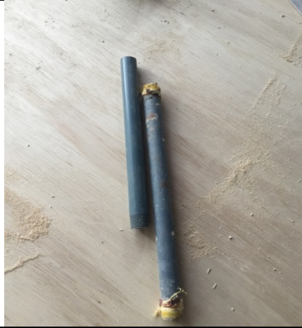
Tubos de 1pulg, para los orificios del desfogue de agua
