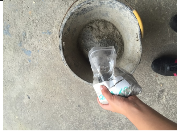
Mezcla de materias primas: Cemento y agregado fino
