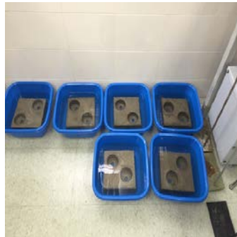
Muestras testigo en el fluido extractante
