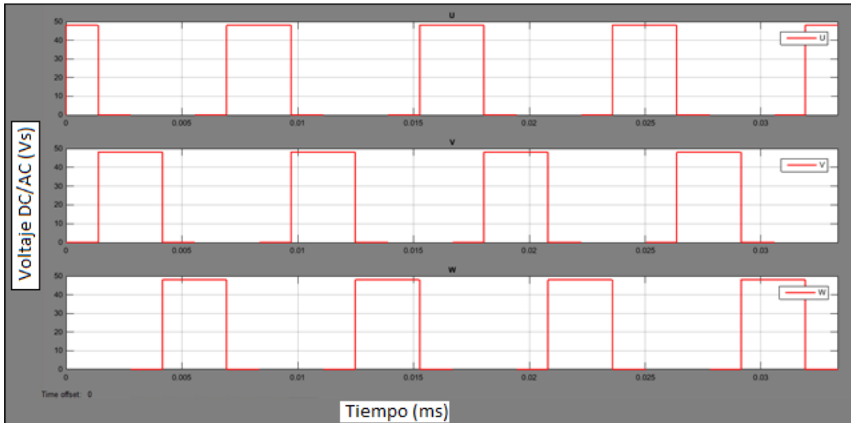
Figura 33. Esquema de conmutación de las fases U, V y W del inversor trifásico.
