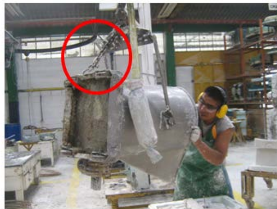
Figura 15. Gancho para sujetar jarra. Elaborado por: Gabriela Arrobo, 2010.
