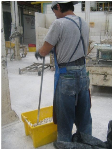
Figura 12. Homogenización de las muestras de desperdicio de yeso. Elaborado por: Gabriela Arrobo, 2010
