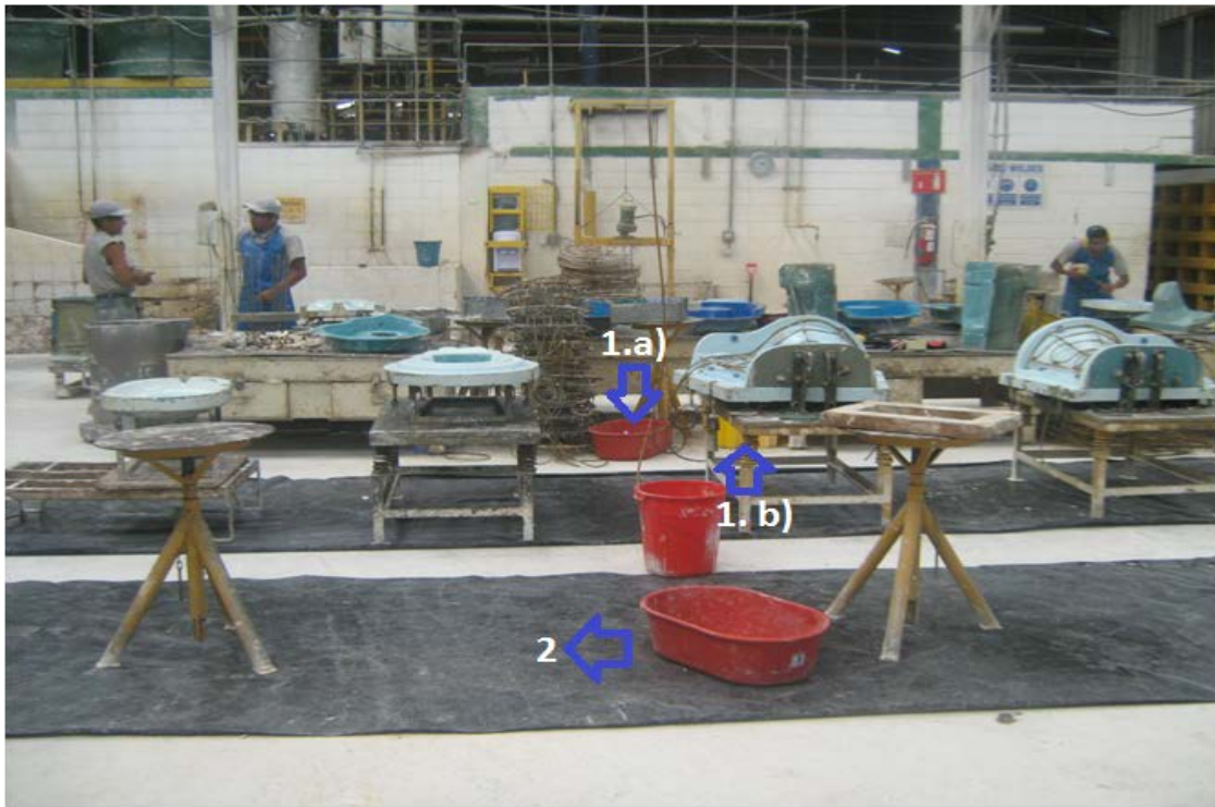
Figura 10. Mediciones de desperdicio de yeso. Elaborado por: Gabriela Arrobo, 2010
