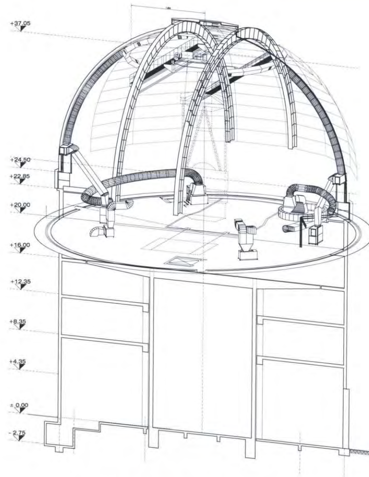
AXONOMETRIA TRANSVERSAL DUCTOS DE VENTILACION EN CUPULA
