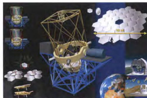
Esquemas de espejo y montura del Gran telescopio de las Canarias
