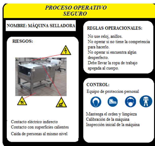
Gráfico 17: Proceso operativo seguro máquina selladora
