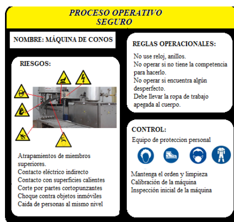
Gráfico 12: Proceso Operativo seguro máquina de conos
