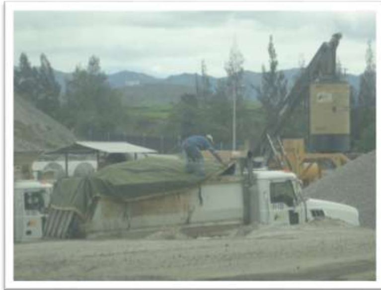
Figura 11. Vehículos de transporte pesado que llevan tierra y que son protegidos con carpas para poder circular
