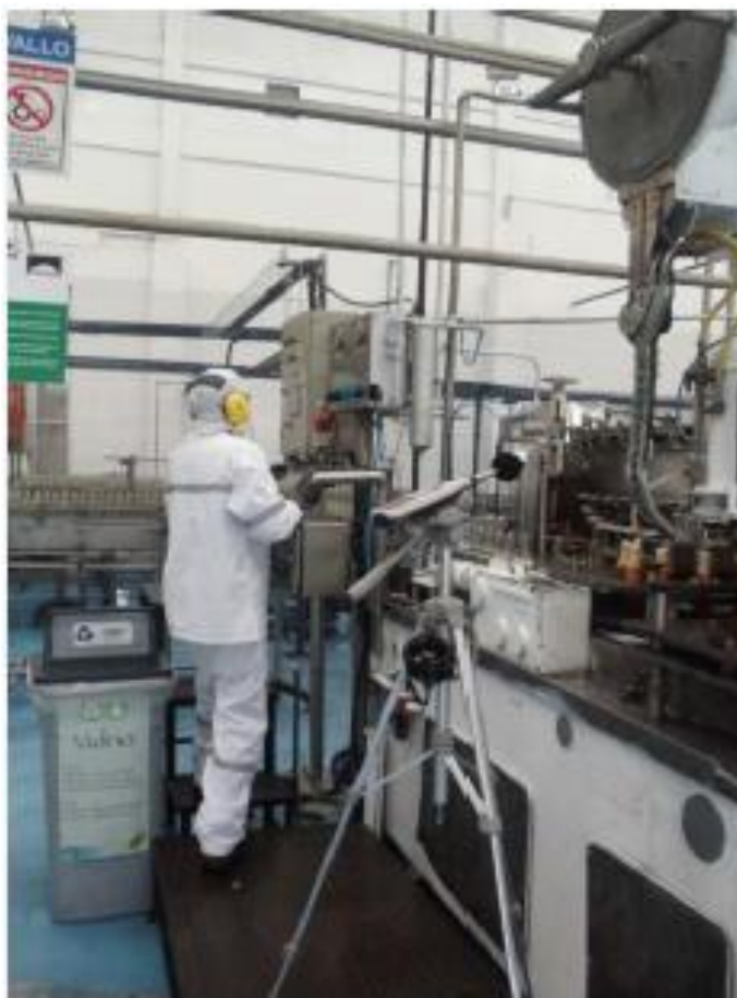
Figura 12. Toma de muestra con sonómetro llenado de agua mineral
