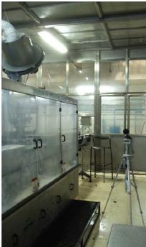
Figura 14. Lectura con sonómetro llenado de Galones/Bidones
