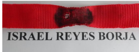
Imagen 19: Daño de una eslinga por calor.
