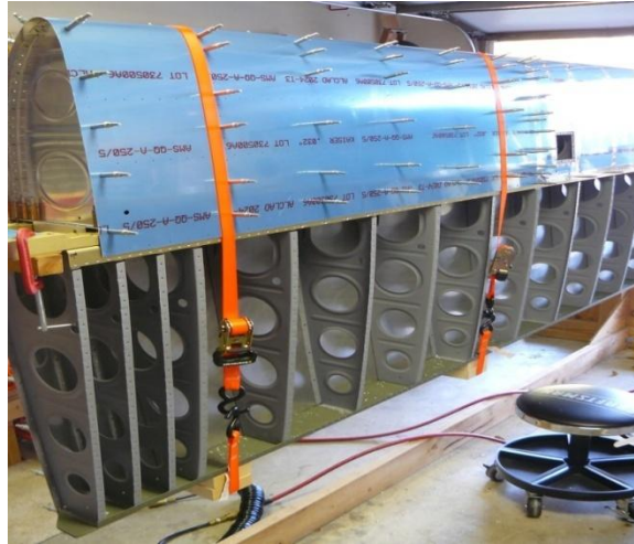
Imagen 8: Eslingas empleadas como prensa para reparar el ala de una avioneta.
