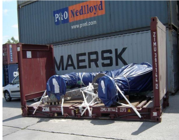
Imagen 6: Eslingas fijando la carga de un flat rack.
