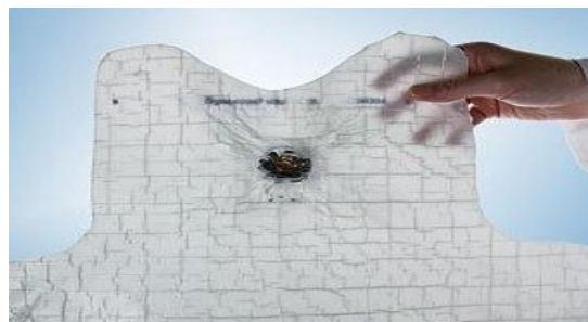
Imagen 24: Chaleco antibalas elaborado con Polietileno de Ultra Alto Peso Molecular
