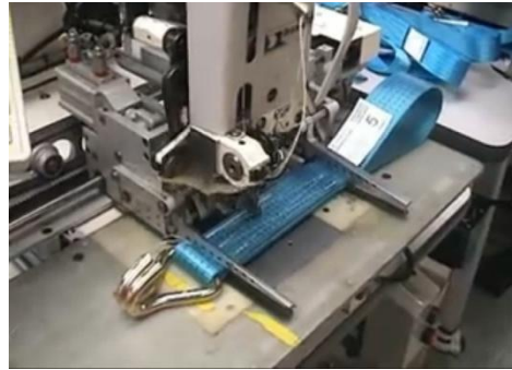
Imagen 35: Fijación de una terminal de acero.
