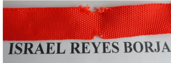
Imagen 20: Daño de una eslinga por corte o perforación.
