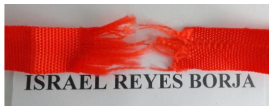
Imagen 18: Daño de una eslinga por ruptura.
