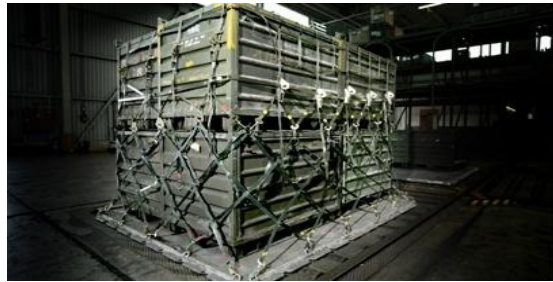
Imagen 26: Red de sujeción elaborada con Polietileno de Ultra Alto Peso Molecular
