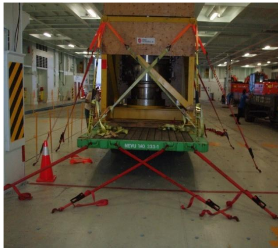
Imagen 7: Amarre de un flat rack para ser transportado.
