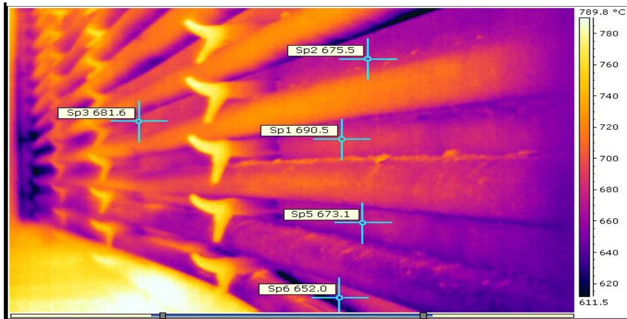
Figura 9. Temperatura de paredes del horno C_H2 de la refin  ria estatal de Esmeraldas en este estudio.
